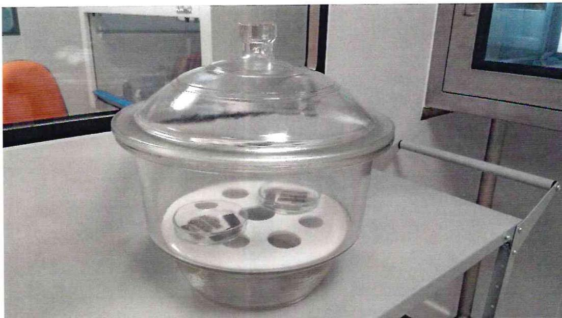
Рисунок 1 – Эксикатор с образцами с налитой на дно водой для поддержания влажности
