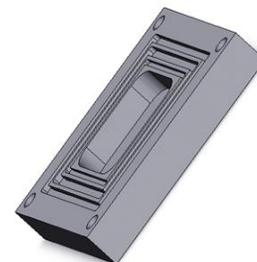
Модель металлической пресс-формы, выполненной на заказ, для изготовления уникальных прокладок по технологии ЗИПСИЛ-ФОРМА
