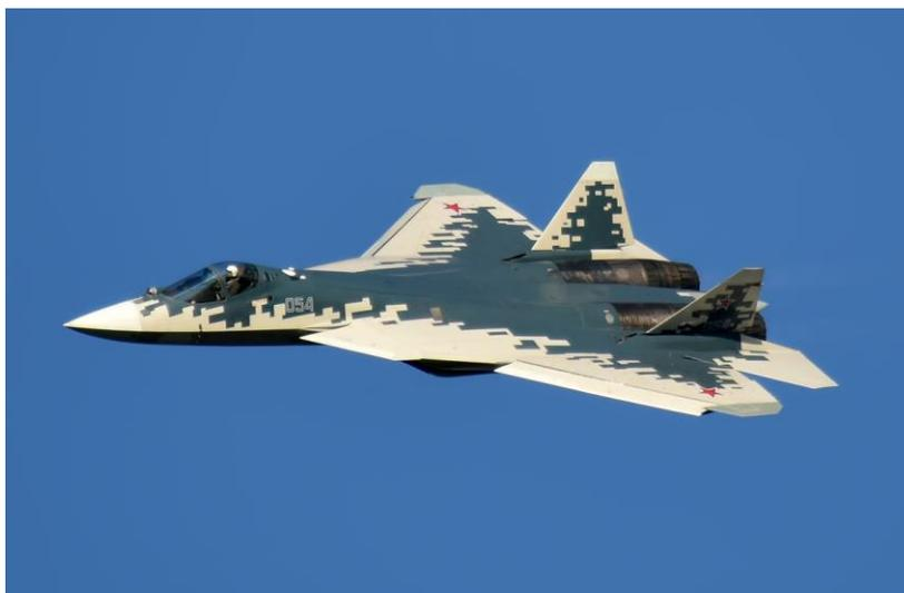
Су-57 — многофункциональный российский истребитель пятого поколения. Разработчик — ОКБ Сухого. Ввиду строгих требований к габаритам авионики самолёта конструкторы активно прибегают к использованию СВЧ-поглощающих материалов сложных форм. Фото — Анна Зверева (CC BY-SA 2.0)
