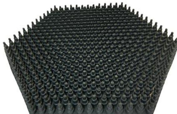
Таблица 1 – Номенклатура термостойких широкополосных поглотителей СВЧ-энергии ЗИПСИЛ 641 РПМ-М4 сложной конусной формы с шестиугольным основанием
